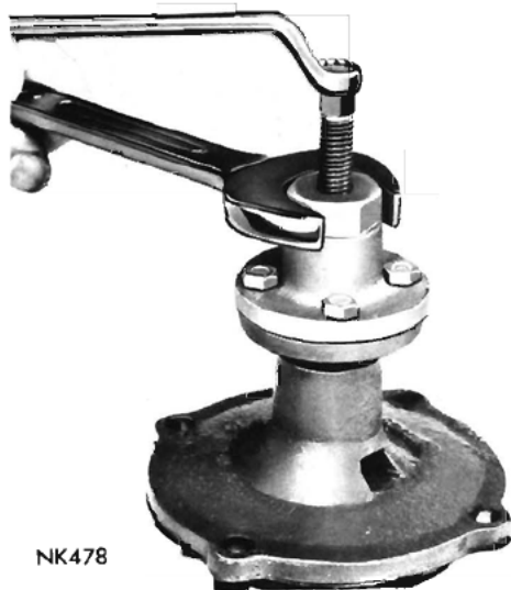
Fig. 8—Removing Fan Hub
